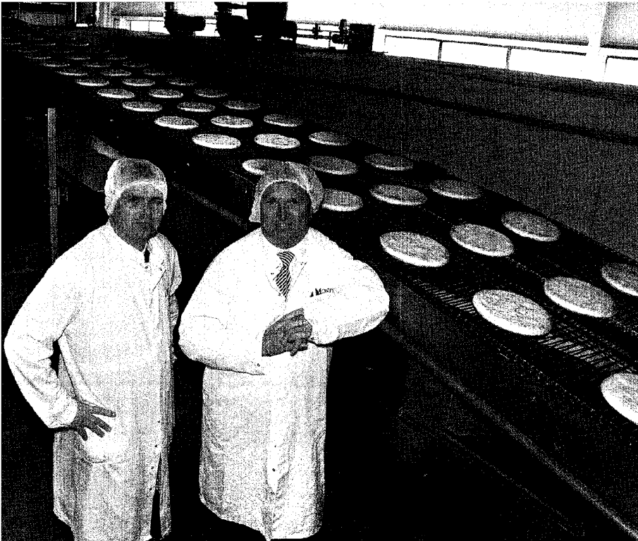
Alexander van de Klouw (links) en Gerhard de Ruiter aan de nieuwe flake-lijn. De zachte flakes kristalliseren op de transportband verder uit. Op de lijn voor harde flakes is deze stap niet nodig.
