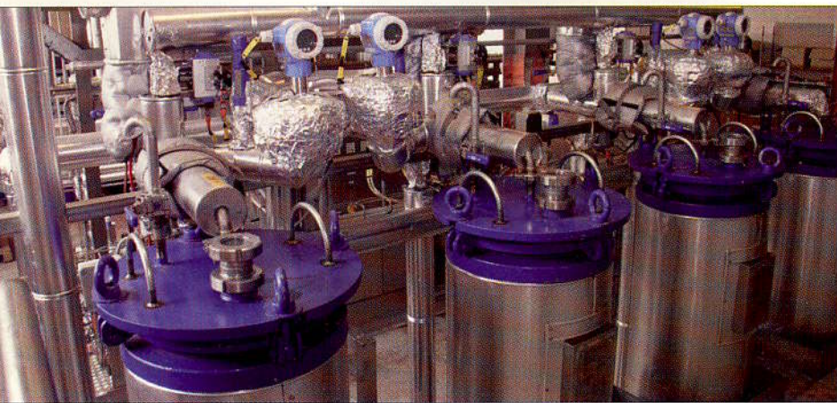
De pilot plant omvat vier gepakte kolommen als reactoren.
